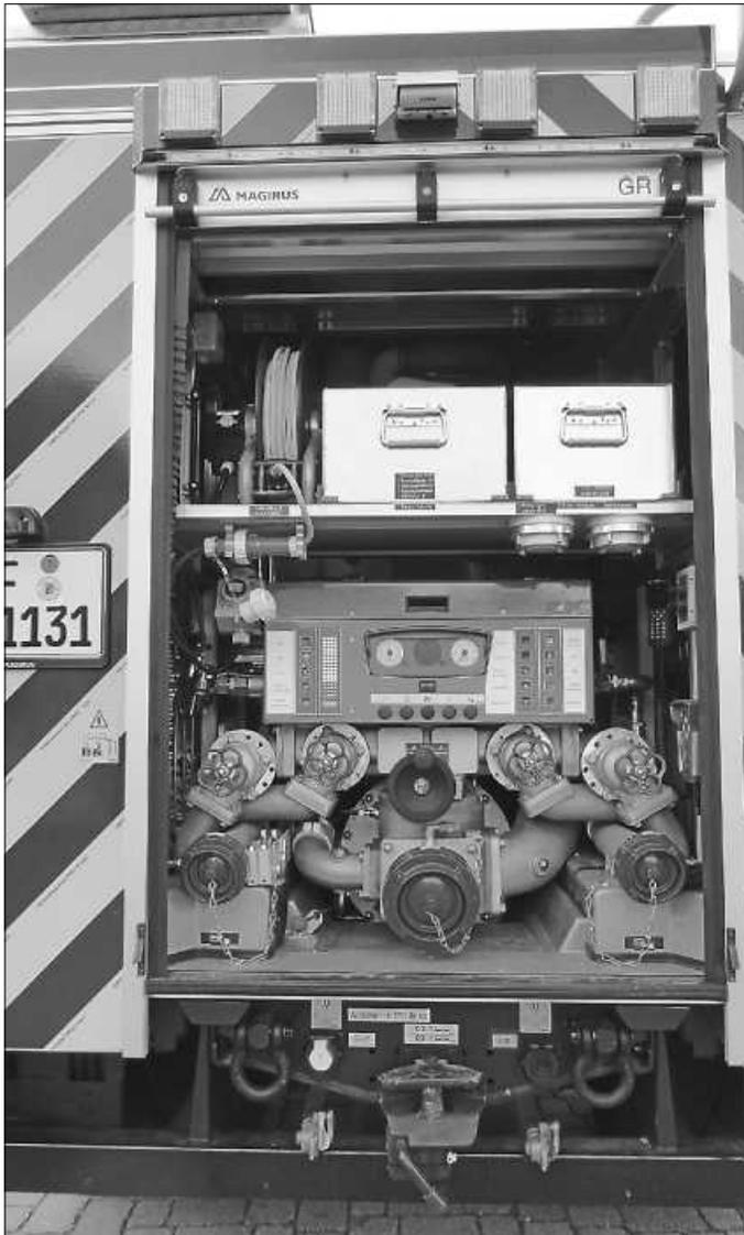
Die andere Besonderheit sehen Sie im 2. Bild. Wir verfügen über einen Schnellangriff Strom. Dies ist eine fest verbaute Kabeltrommel mit automatischem Einzug und einem 23 m langen Kabel, welches direkt mit dem Stromerzeuger verbunden ist. Am Ende des Kabels ist ein 3-fach-Verteiler angeschlossen und somit können mehrere Geräte mit Strom versorgt werden. Müssen bei einem Einsatz stromangetriebene Geräte eingesetzt werden, startet der Maschinist umgehend den Stromerzeuger und eine
